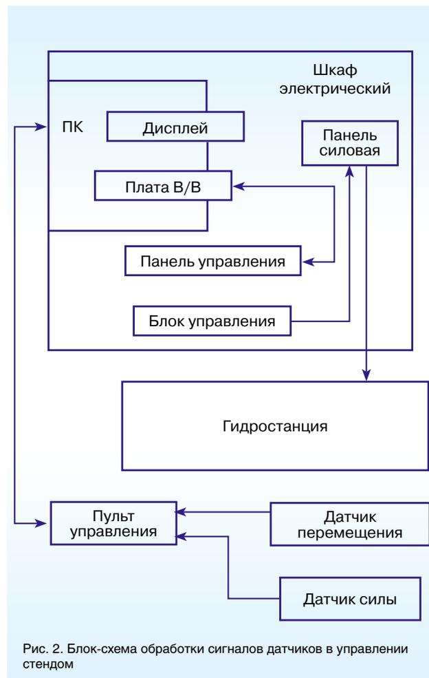
Рис. 2. Блок-схема обработки сигналов датчиков в управлении стендом
