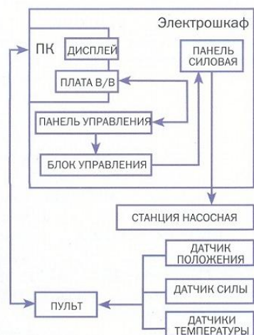
Рис. 2. Блок-схема обработки сигналов датчиков и управления стендом
