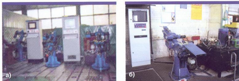
Рис. 1. Стенды серии СВД: а) специализированные стенды СВД 11-0,047 ПТЗ для испытания гасителей типа НЦ 1100; б) перенастраиваемые СВД 16-0,3ПТЗР для испытания широкой номенклатуры гасителей, в т. ч. фирмы KONI
